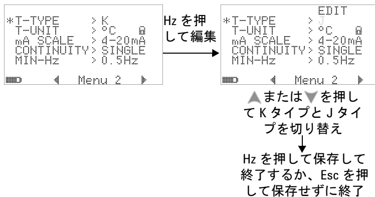
図 4-7 熱電対タイプのセットアップ
